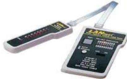
Gambar test koneksi kabel stright
