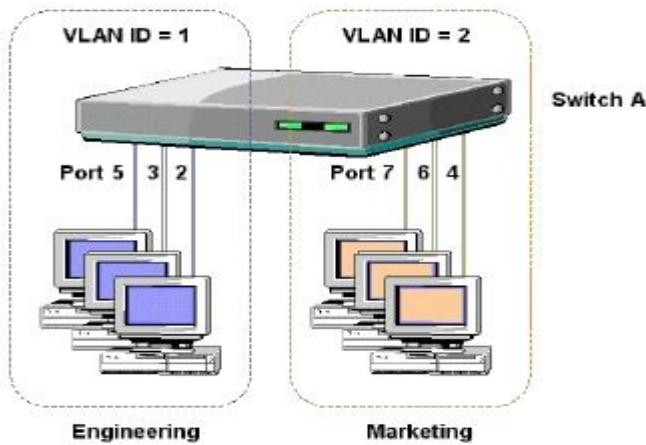
Gambar 6.3. Pembagian port pada switch untuk VLAN
