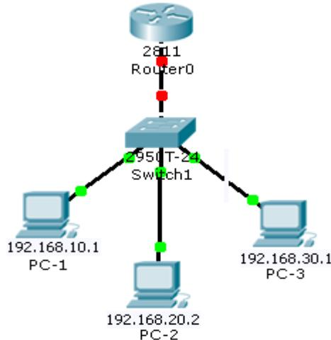
Gambar 7.1. VLAN dengan Router
