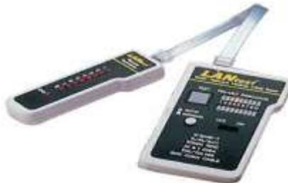
Gambar test koneksi kabel straight
