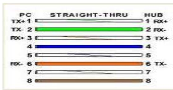
Gambar konfigurasi straight cable
