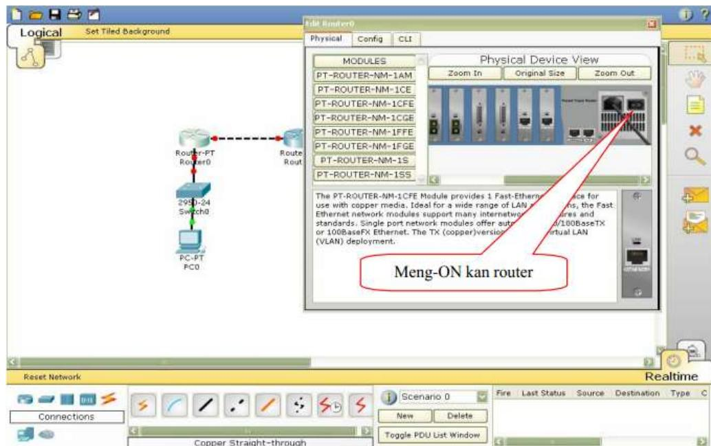
Gambar 2.12 Router di ON kan
