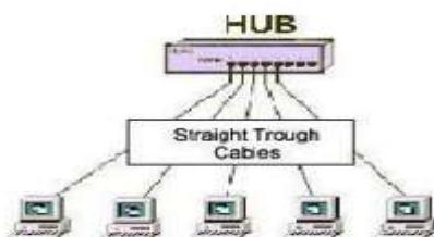
Gambar penggunaan kabel *straight through cable*
