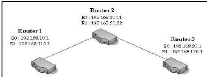
Gambar 3.1 Konfigurasi 3 router
