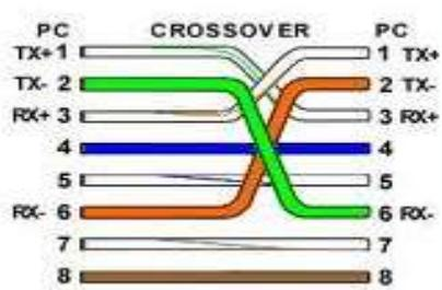
Gambar konfigurasi kabel cross over
