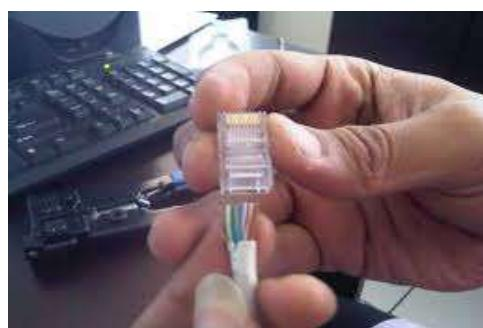
Gambar posisi RJ 45 saat memasukan kabel
