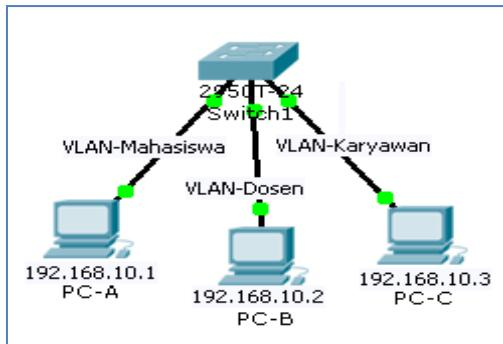
Gambar 6.1. Konfigurasi switch dengan 3 VLAN tanpa Router
