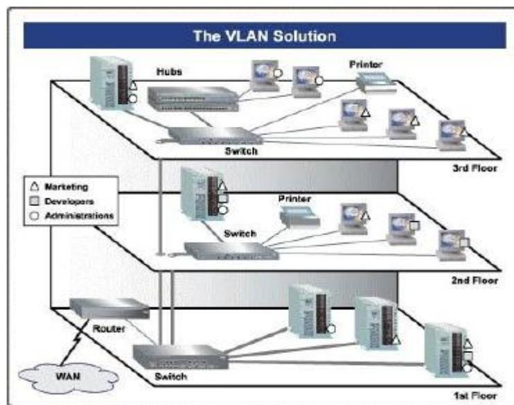
Gambar 6.4. Penerapan VLAN dalam sebuah gedung
