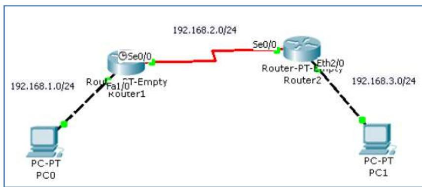
Gambar.3.2 Routing dengan 2 router
