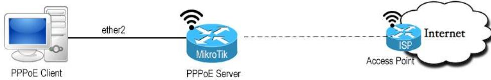
Kita akan melakukan konfigurasi PPPoE seperti gambar diatas, dimana router MikroTik akan menjadi *PPPoE server*, terhubung dengan koneksi internet melalui *Access Point (wlan1)*, dan terkoneksi dengan PC Client melalui interface *ether2*. Untuk langkah konfigurasi nya, bisa lihat seperti dibawah ini
