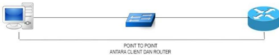
Bisa kita lihat gambar diatas, PC Client dan Router terhubung melalui sebuah switch. Tetapi, dengan teknik *Point to Point* ini, nantinya PC Client seolah olah terhubung langsung dengan Router, atau istilahnya *face-to-face* dengan router.
