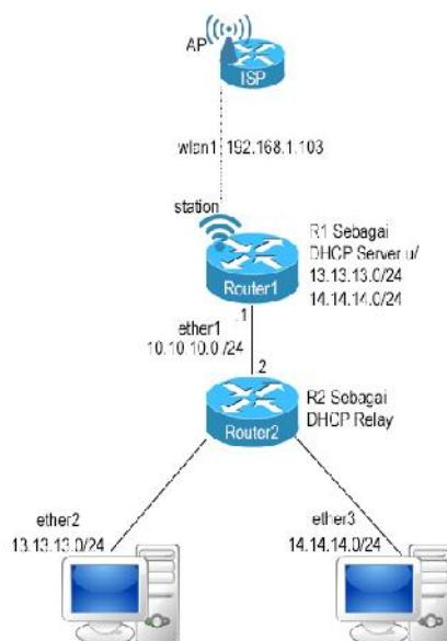
Seperti kita lihat diatas, terdapat 2 router MikroTik tersambung melalui interface ether1. Router 1 nantinya akan berperan sebagai DHCP Server, lalu Router 2 akan menjadi DHCP Relay. Router 1 nantinya akan menjadi DHCP Server untuk semua jaringan local yang terhubung dengan router 2, *in this case* yaitu 13.13.13.0/24 dan 14.14.14.0/24. Kita langsung saja ke langkah konfigurasi DHCP Server dan DHCP Relay
