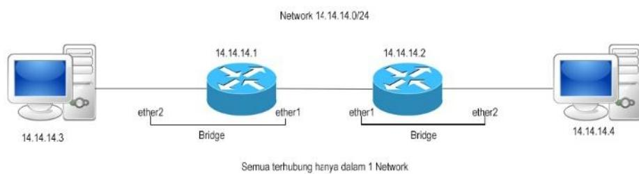
Setelah semuanya terhubung, kita akan membuat interface *bridge* pada Router MikroTik 1. Untuk langkah konfigurasi nya adalah sebagai berikut :
