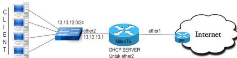
Bisa kita lihat gambar diatas, Router MikroTik bertindak sebagai DHCP Server bagi PC Client yang terhubung dengan Router melalui interface *ether2*
