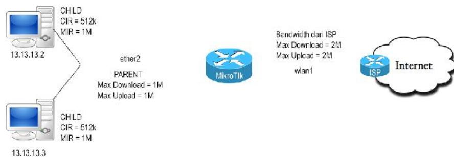
Bisa kita lihat gambar topologi diatas, terdapat 2 PC Client pada Router MikroTik yang terhubung melalui interface *ether2*. Yang pertama kita konfigurasikan adalah Marking atau Firewall Mangle nya terlebih dahulu. Untuk langkahnya sendiri sama seperti sebelumnya, hanya saja disini kita tambahkan lagi untuk Client 2. Agar lebih jelasnya bisa lihat konfigurasi dibawah ini :
