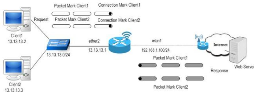
Untuk melakukan *marking* pada topologi diatas, kita hanya perlu melakukan konfigurasi marking 1 per 1 untuk client tersebut. Langsung saja kita mulai konfigurasi marking untuk client dengan IP 13.13.13.2
