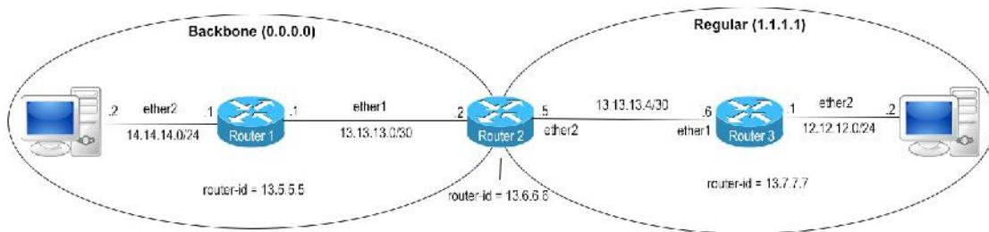
Oke, kita langsung saja menuju langkah konfigurasinya. Pertama, kita akan *mengaktifkan routing protocol OSPF* pada interface Router. Untuk langkahnya sendiri hampir sama seperti Single Area, perbedaan nya disini terletak pada Router 2 dimana kita akan mengaktifkan interface *ether1* dan *ether2* karena pada Router 2 kedua interface tersebut terhubung dengan Router OSPF lain nya.
