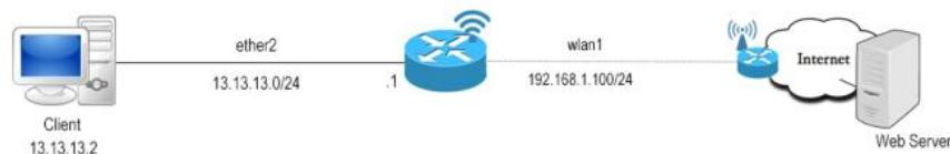
Bisa lihat gambar diatas, Router mempunyai 1 Client melalui Interface *ether2* lalu Router terhubung dengan internet melalui interface *wlan1*. Disini kita akan melakukan *Marking* pada *Traffic Upload* dan *Download* yang dilakukan oleh Client.
