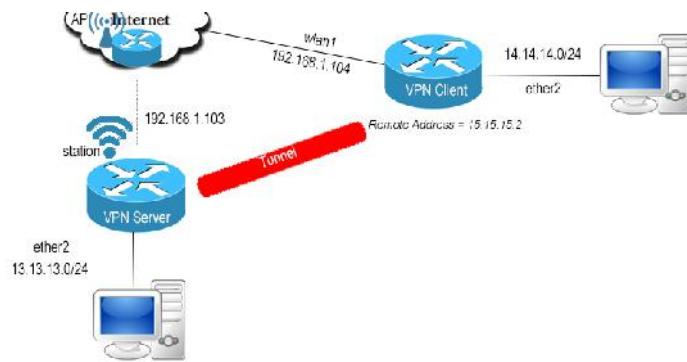
Bisa kita lihat gambar diatas, terdapat 2 router MikroTik dengan masing masing PC Client. Router MikroTik 1 bertindak sebagai *PPTP Server*, lalu Router MikroTik 2 sebagai *PPTP Client*.
